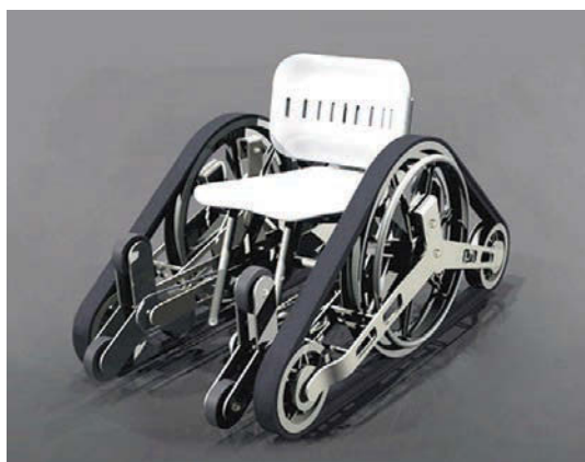
Sl. 22. Koncept invalidskih kolica koja bi trebala omogućiti penjanje uz stepenice i silazanje niz njih
