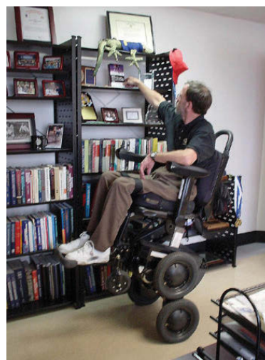
Sl. 33 i sl. 34. Mogućnosti iBOTA: kretanje stepenicama i uspravljanje
